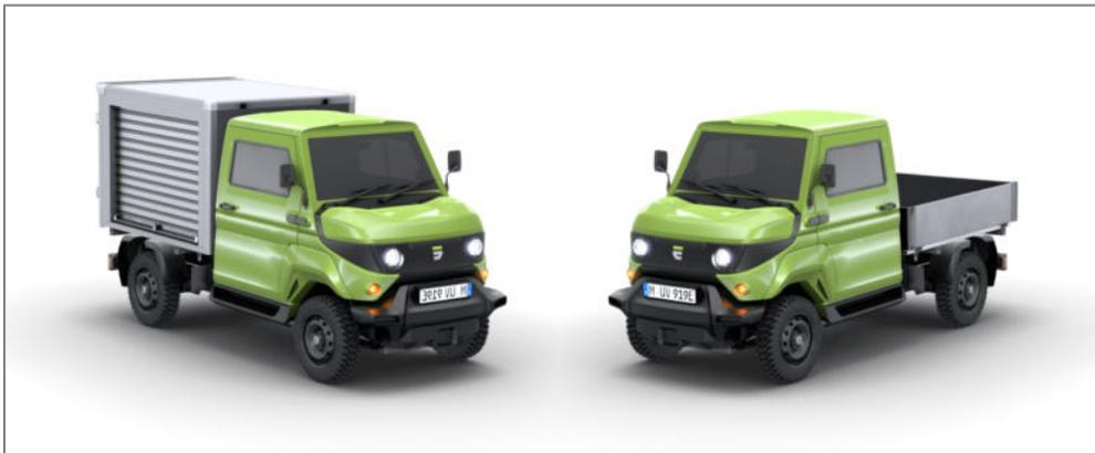
EVUM ist ebenfalls ein Spin-off aus dem Hochschulbereich, in diesem Fall ein Projekt der Technischen Universität München. Unter der Typbezeichnung "aCar" wird ein kompakter, elektrisch angetriebener Kleintransporter mit Allradantrieb hergestellt.
